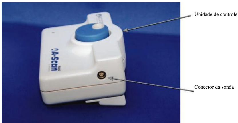
Figura 3-1 Unidade de controle e conector da sonda (lado direito do instrumento)
